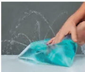
Рис. 23.5. Вода передає додатковий тиск у всі боки і внаслідок цього виходить із пакета в усіх напрямках
