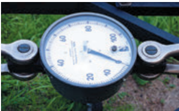
Рис. 19.11. Тяговий динамометр, призначений для вимірювання великих сил, наприклад сили тяги трактора
