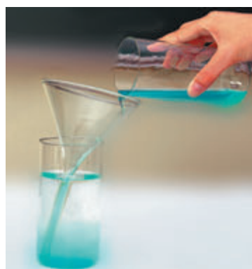
Рис. 2.4. За допомогою лійки можна акуратно налити розчин мідного купоросу на дно склянки з водою
