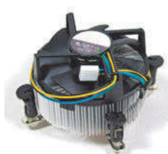
Рис. 12.4. Обертова частота кулерів сучасних процесорів становить 50–60 обертів за секунду
