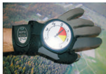
Рис. 25.6. Альтиметр на руці парашутиста
