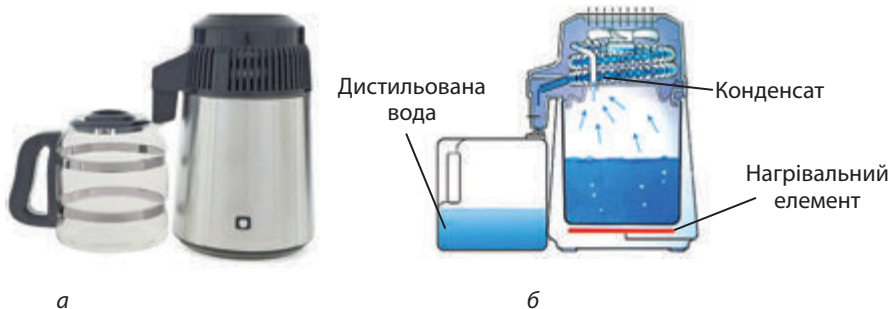
Мал. 118. Дистильатор — пристрій для повного очищення води: а — зовнішній вигляд; б — внутрішня будова. Він являє собою бак із нагрівальним приладом. Вода в баку постійно кипить, а водяна пара конденсується в спеціальній ємності — приймачі
